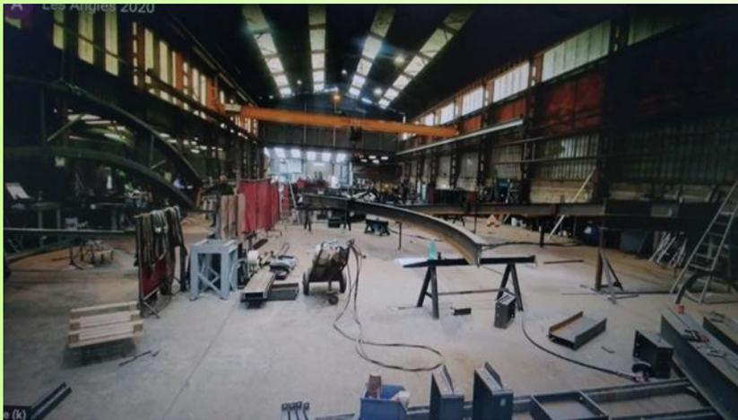
Les différentes pièces sont assemblées en atelier avant les fixations finales sur chantier pour s'assurer de la conformité des assemblages. Puis elles sont transportées pour certaines vers une société de traitement en galvanisation avant d'être acheminées sur le chantier par camion de différents tonnages dont des convois exceptionnels
